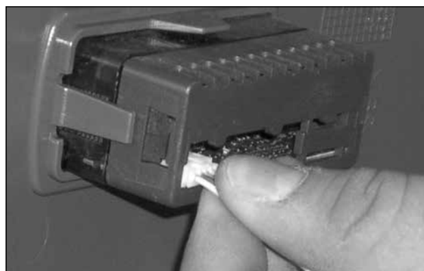
44. ábra: A csatlakozó kihúzása a kijelzőből (2)
