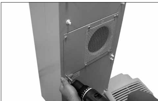
68. ábra: Lazítsa meg a külső keringetőventilátor négy csavarját
