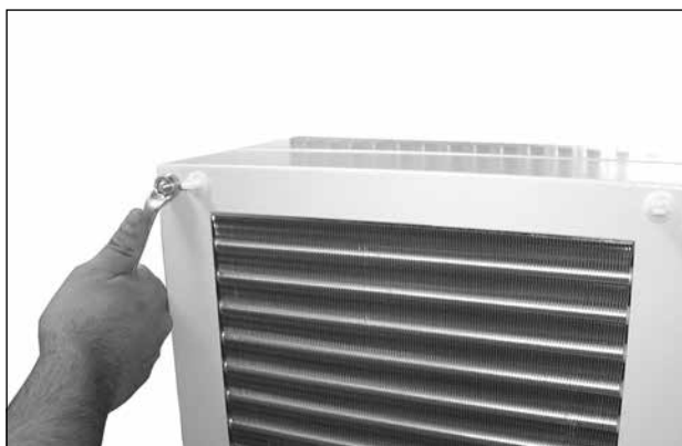
49. ábra: Vegye le a fedelet (a négy csavart lazítsa ki)
