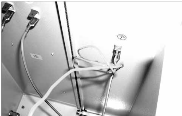
73. ábra: Húzza ki a ventilátor földelőkábelét (1)
