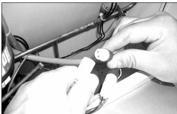
72. ábra: Húzza ki a ventilátorok csatlakozóját (3)
