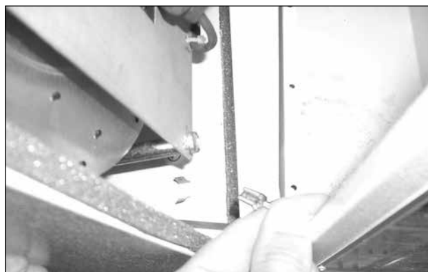
55. ábra: Csavarozza le a fedél és a váz közötti földelőkábelt (2)
