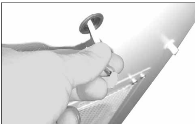
66. ábra: Nyomja vissza a kijelző kábelét és nyomja át a kábelhüvelyen (1)
