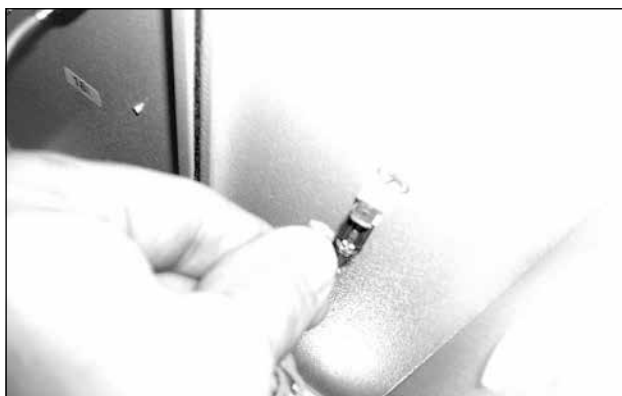
74. ábra: Húzza ki a ventilátor földelőkábelét (2)
