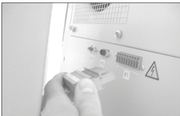
39. ábra: A hálózati csatlakozó kihúzása
