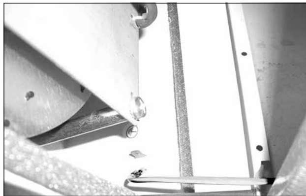
54. ábra: Csavarozza le a fedél és a váz közötti földelőkábelt (1)
