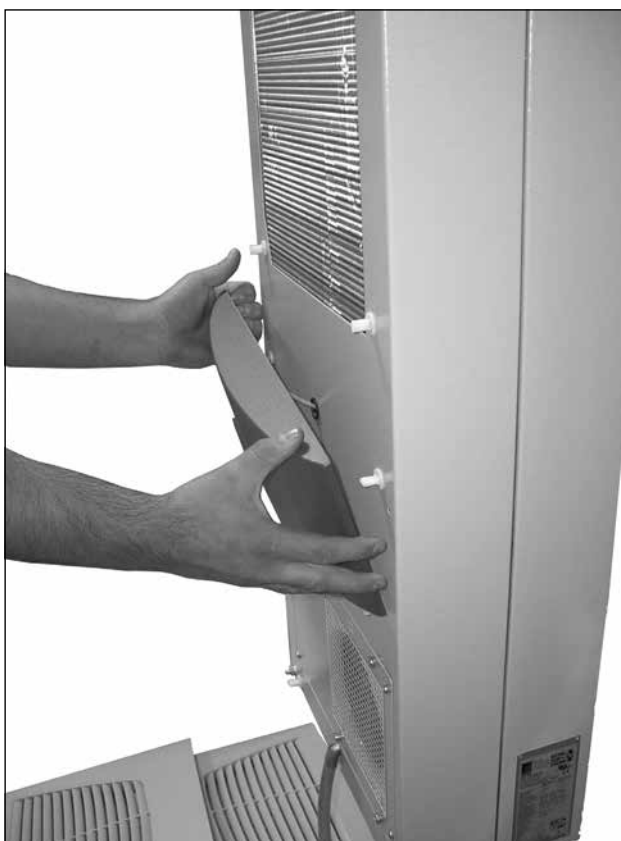
42. ábra: A közpanel eltávolítása
