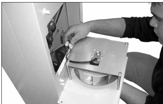
70. ábra: Húzza ki a ventilátorok csatlakozóját (1)
