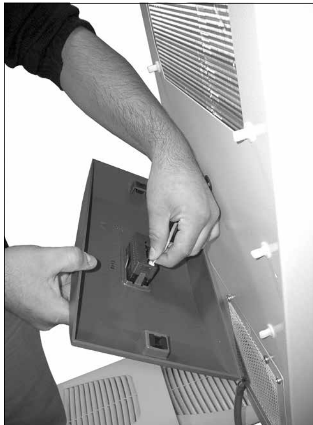
43. ábra: A csatlakozó kihúzása a kijelzőből (1)
