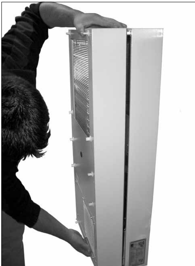
52. ábra: A burkolat levétele (1)
