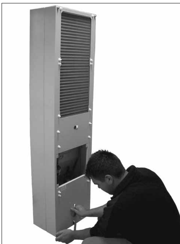
75. ábra: Csavarja ki a fedél négy csavarját
