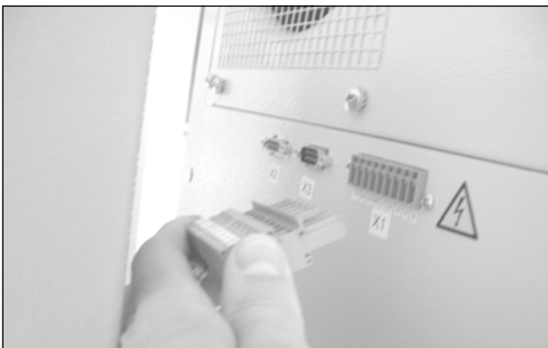
58. ábra: A hálózati csatlakozó kihúzása
