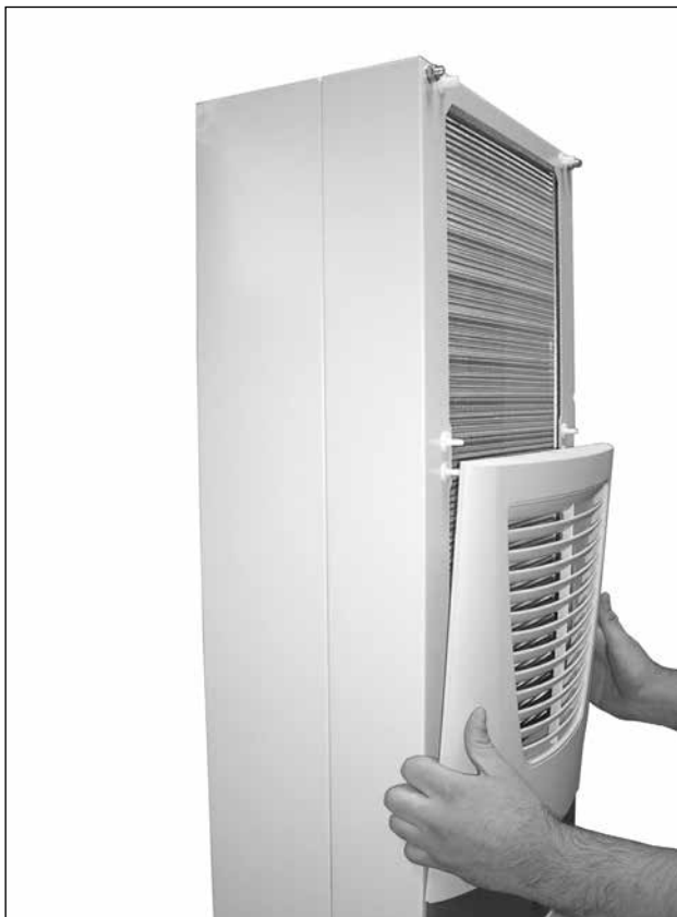
61. ábra: A felső lamellarács eltávolítása (3)
