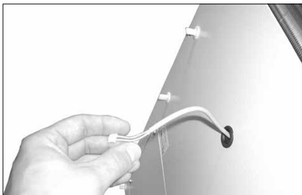
50. ábra: Nyomja vissza a kijelző kábelét
