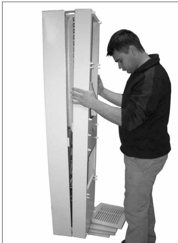
76. ábra: A fedél eltávolítása
