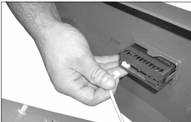
65. ábra: Húzza ki a kijelző kábelét
