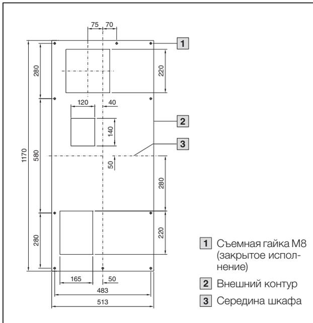
Рис. 2: Монтажный вырез CS 9761.212
