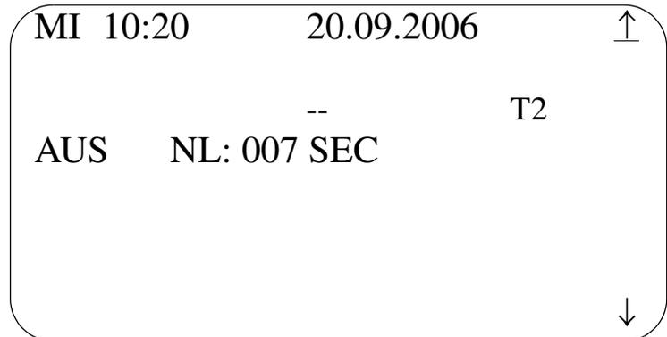
Abb. 8: Displayanzeige während der Ausschaltsequenz
