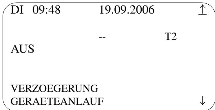
Abb. 4: Displayanzeige der Anfahrsequenz nach dem Einschalten
