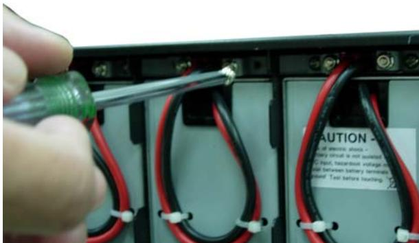
4. Die Anschlüsse der Hot Swap Batterie, wie in Schritt 4 beschrieben herausziehen.
