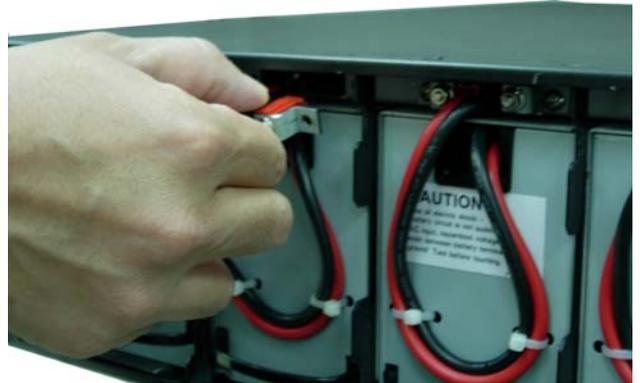
5. Entnehmen Sie die Batteriepakete, wie in Schritt 5 aus dem Batteriefach.
