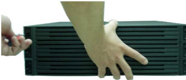
3. Schraube des Batteriepacks, wie in Schritt 3 beschrieben abschrauben.
