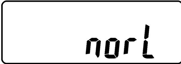
Abb.V1: Die USV arbeitet im "Normalbetrieb"
