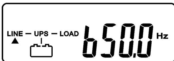
Abb. K Bypass-Eingangsfrequenz
