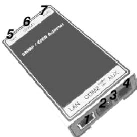
1. RJ-45 Buchse für Netzwerkanschluss 10/100 Base-T (autom. Umschaltung)
