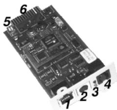
Die interne SNMP-Steckkarte kann in einem entsprechenden Steckplatz der **PMC 800** eingesetzt werden. Dieser Adapter kommuniziert mit der USV via serielle Schnittstelle und ermöglicht einen den Shutdown von mehreren Servern ohne zusätzliche SNMP Management Software.
