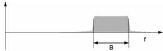
Abbildung 2 Das Leistungs-Spektrum (Bandbreite B) eines Chirp-Impulses im Frequenzbereich  $f$ <sup>1</sup>
