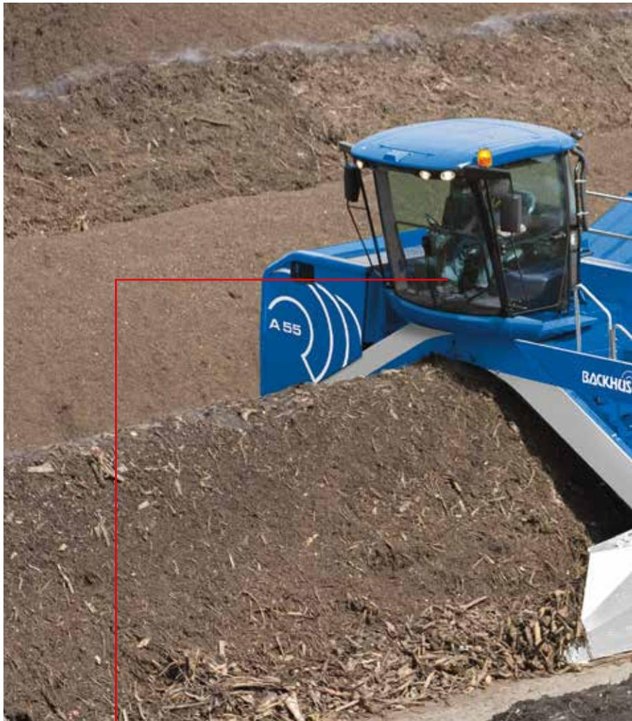
**W**er seine Gartenabfälle kompostiert, der weiß: Ab und zu muss man zum Spaten greifen und den Kompost umschichten. Nur dann zerfällt das Material gleichmäßig, und es kann ein hochwertiges Substrat entstehen. Bei großtechnischen Anlagen übernehmen Umsetzer diese Aufgabe. Sie bewegen sich auf einem Raupenfahrwerk und durchmischen mit einem Rotor die dreiecksförmige Miete, indem sie buchstäblich das Unterste nach oben bewegen und umkehrt.
