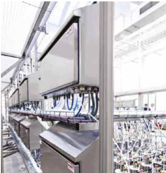
Figura 1: Contenitori Rittal in acciaio inox per le linee di processo di Friesland-Campina
