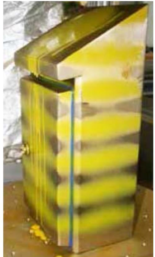
Abbildung 11: Die Verschmutzung des HD-Gehäuses im Versuch.
