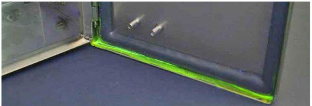
Abbildung 12: Nach der Reinigung eines herkömmlichen Gehäuses sind nicht alle Verschmutzungen beseitigt.
