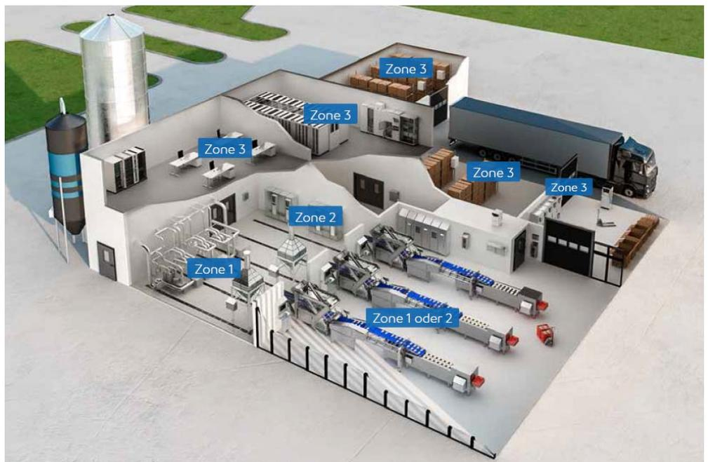
Abbildung 4: Schematische Darstellung der Hygienezonen eines Unternehmens. Es werden prinzipiell drei Zonen unterschieden: Lebensmittelbereich (Zone 1), Spritzbereich (Zone 2) und Verpackungs- und Nicht-Lebensmittelbereich (Zone 3).
