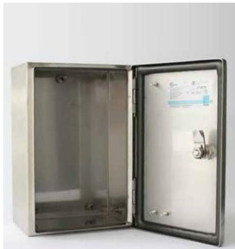
Abbildung 6: Bei einem nicht im Hygienic Design konzipierten Gehäuse befinden sich zum Beispiel die Scharniere außerhalb des Dichtungsbereichs.
