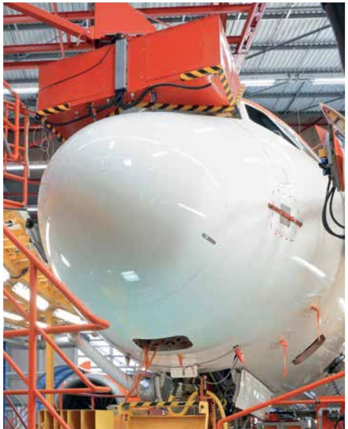
数字视图 工程师无法看见绝美的空中景象：显示器安装在驾驶舱前，用以显示地面测试指令。
