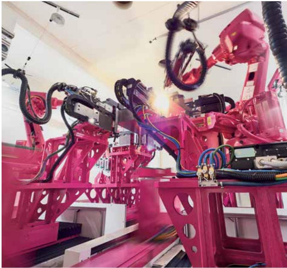
**创新** 威图目前使用激光焊接打造折叠式机柜的终极几何形态。该方法能够加快焊接过程并减小焊缝，从而提高焊接效率和品质。
