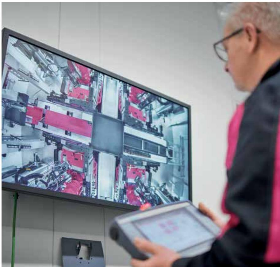
**监控** 焊接工作站4.0的工厂操作人员通过大屏幕观察焊接过程，监控和控制焊接机器人作业。这种方法对员工更安全。
