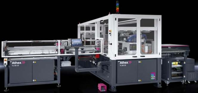
Athex TC 80 CS 자동 단자 조립 기계는 EPLAN Pro Panel의 데이터 또는 수동으로 구성된 XML 형식의 데이터를 처리함. 가공하는 동안 서포트 레일이 버퍼 스토어에서 자동으로 측정 및 절단되고, 그런 다음 바닥면에서 시운전/프로젝트 플래닝을 위해 바늘인 그레이버를 통해 표시됨. 추가 작업 단계에서 필요한 단자는 그리퍼 시스템을 이용해 단자 스트립에 직접 장착하거나 선택적으로 배치 전에 레이저 마킹 시스템으로 라벨링됨. 생산 완료된 단자 스트립은 분류 장치를 통해 기계에서 배출되며 제거할 수 있음.
