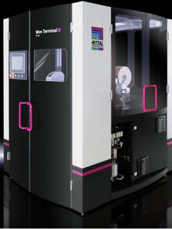
새로운 콤팩트 전자동 와이어 프로세싱 장치 Wire Terminal WT 를 통해 단면적 0.5mm<sup>2</sup> ~ 2.5mm<sup>2</sup> 의 다양한 와이어를 최대 36 개까지 수동 작업 없이 완전 자동화 방식으로 생산할 수 있음.
