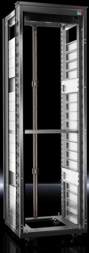
ОСР-стойка, 41 OpenU (OU), для применения в энергоэффективных ИТ-архитектурах по принципу проекта Open Compute. В зависимости от варианта с разделенной шиной 12 В DC, смонтированной сзади, или без шины для индивидуальной конфигурации. В зависимости от комплектующих и количества используемых блоков питания в стойке могут быть использованы одна (single) или две (dual) зоны питания.
