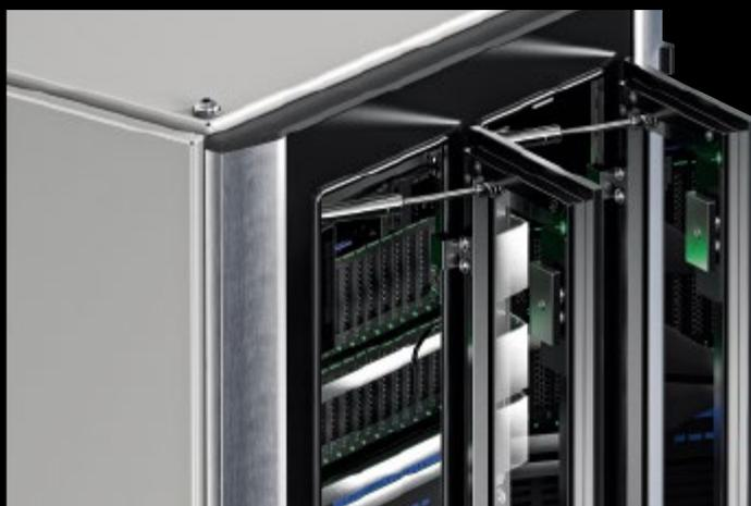
Les portes VX IT avec ADO possèdent des volets d'aération intégrés et un module de contrôle des portes (DCM) pour la commande. Une température excessive dans la baie fermée ou l'ouverture pour le gaz d'extinction avec une installation d'extinction externe constituent des scénarii d'utilisation.
